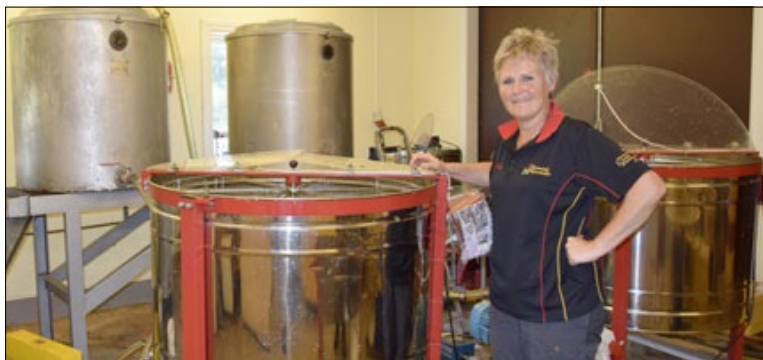
I anläggningen på gården Rosendal förädlas honungen i flera steg. I dessa behållare, som fungerar som en centrifug, slungas honungen och befrias från vax.
